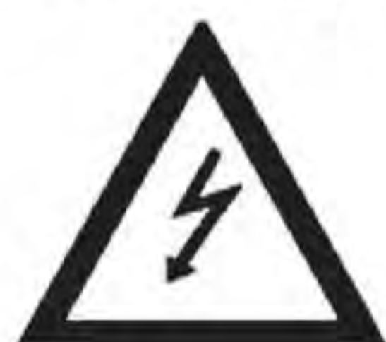
خطر برق گرفتگی
